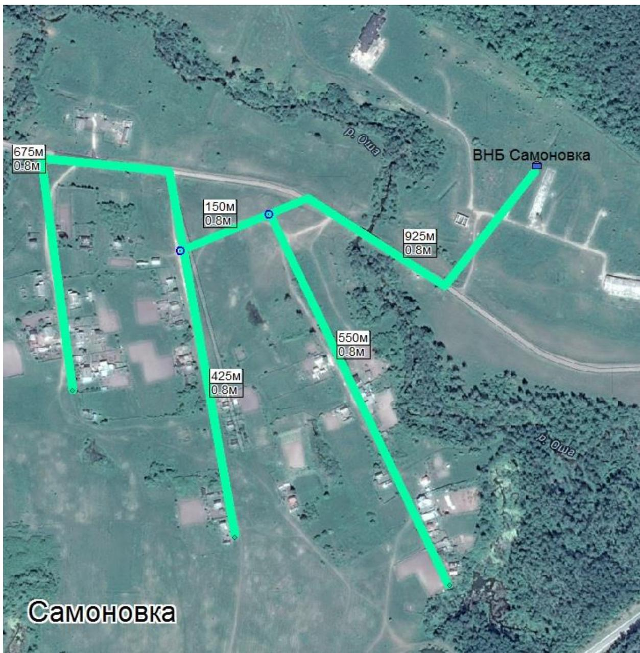
**Рисунок 1-7. Зона централизованного водоснабжения н.п. Самоновка**
