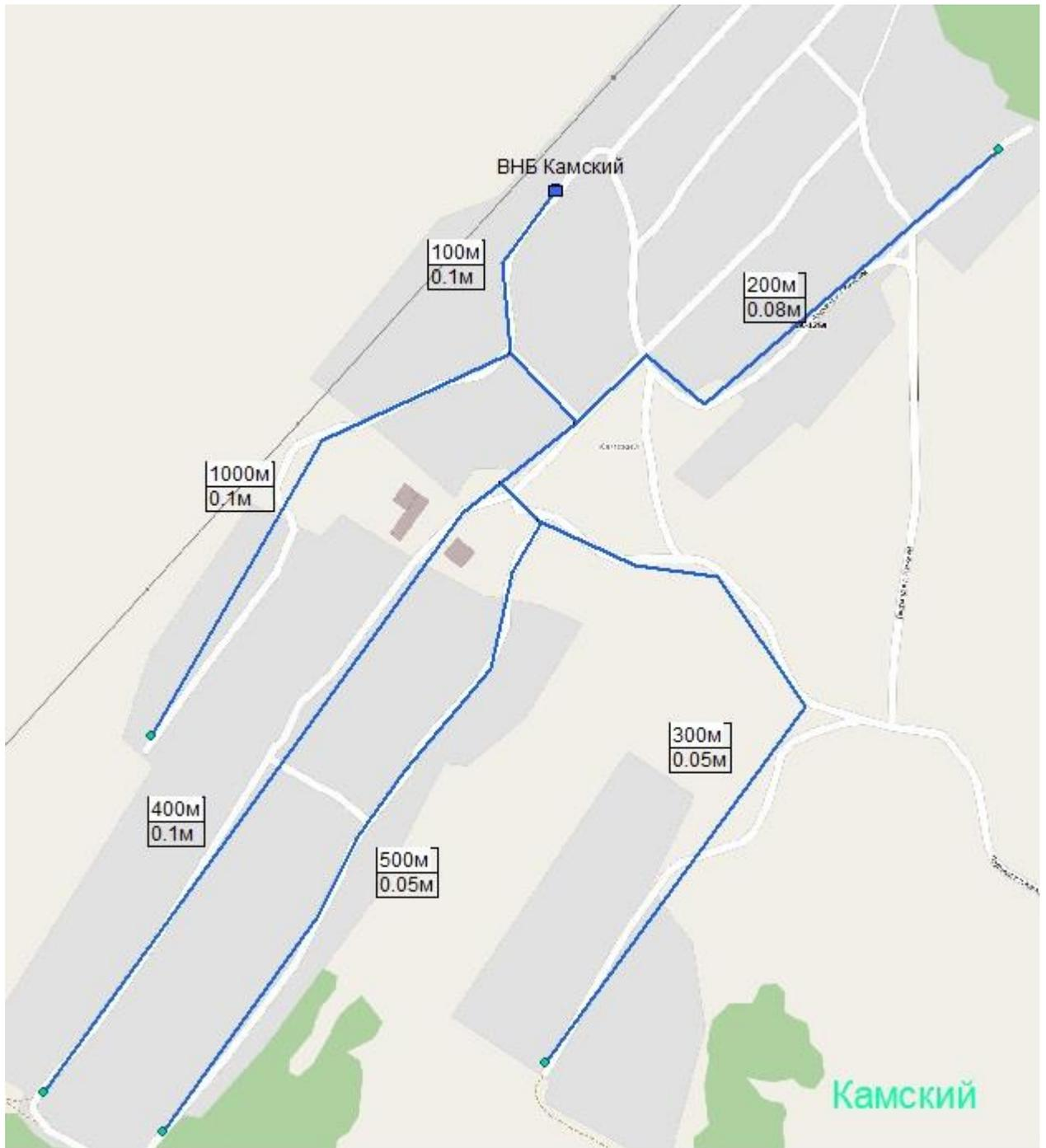
**Рисунок 1-4. Зона централизованного водоснабжения н.п. Камский**
