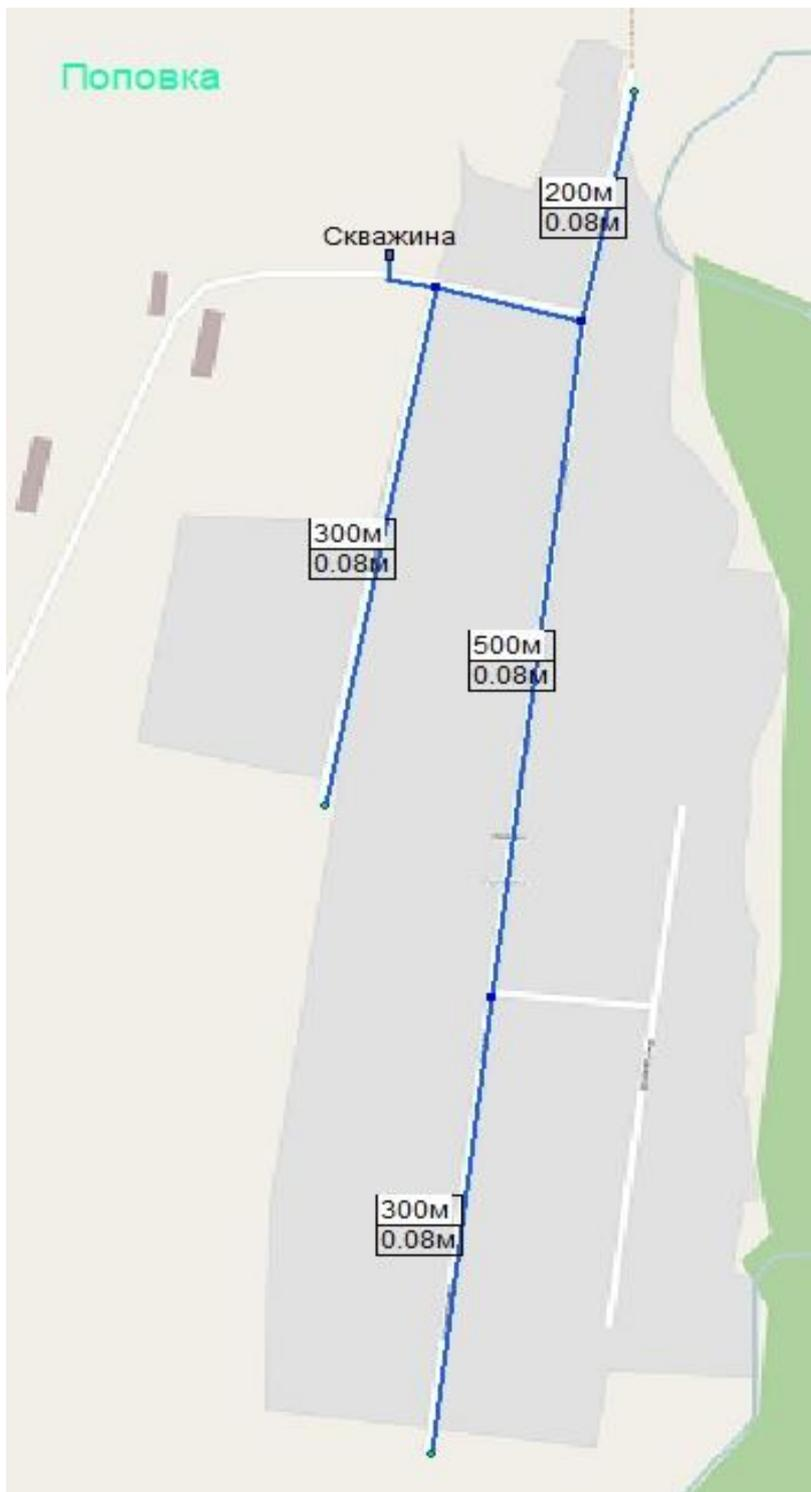
**Рисунок 1-6. Зона централизованного водоснабжения н.п. Поповка**
